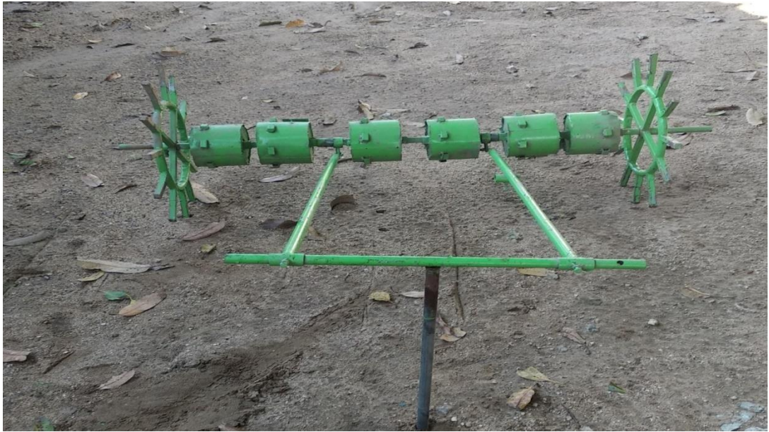
တန်းခြား၊ပင်ခြား စပါးတိုက်ရိုက်မျိုးစေ့ချက်ရိယာ
