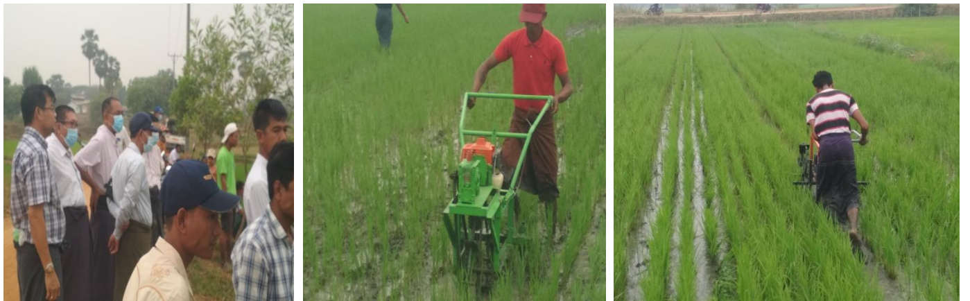
အသေးစားစပါးကြားပေါင်းလိုက်စက်ဖြင့် တန်းကြား ပေါင်းမြက်နှိမ် တမန်းနှိုး
